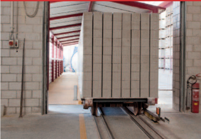
Bild oben: hydraulische Presse formt die Kalksandstein-Rohlinge Bild unten: Transport auf die vollautomatische Schiebebühne
