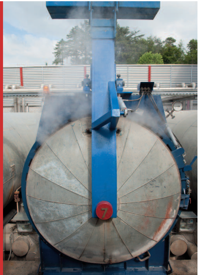
Mehr Sicherheit und Energieeffizienz durch vollautomatisches Öffnen und Schliessen der Autoklaven.
