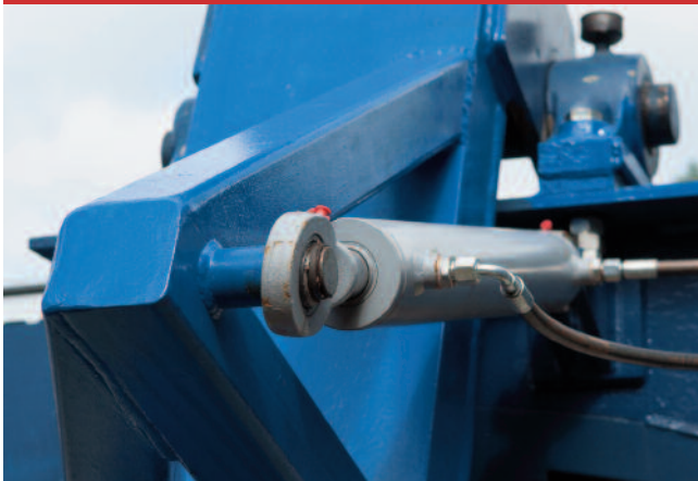
Bild oben: Steuerungspanel der Schiebebühnen-/Autoklavenanlage Bild unten: hydraulischer Zylinder der neuen Schliessautomatik
